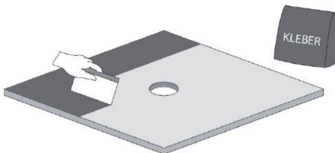
Herstellen eines planen Untergrunds. Evtl. Rohrführungsschächte sind mit Füllmaterial aufzufüllen. Auf der Unterseite vom Planopor Basic wird mit einem 8 mm Zahnpachtel ein vergüteter Dünnbettmörtel aufgetragen.
