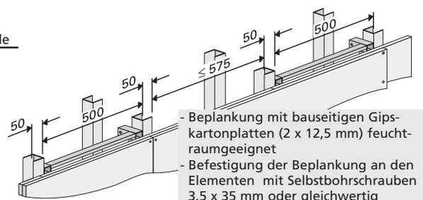
2. Vorwandssystem mit Leichtbauprofilen
