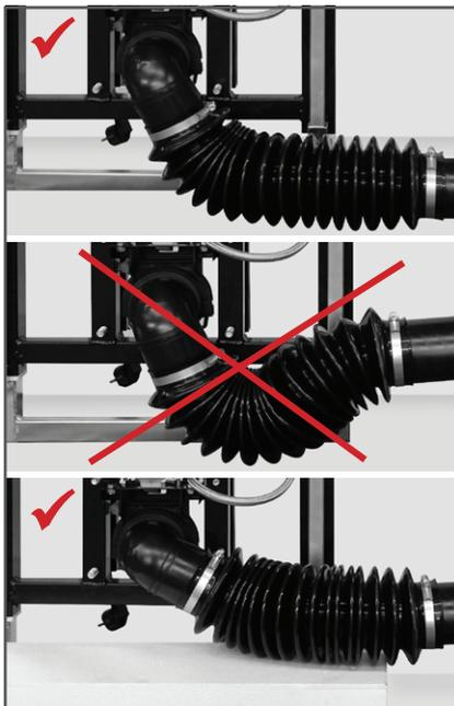
**22.** Abwasserrohr anschließen (nicht knicken)
