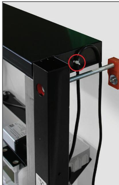
**23.** Netzkabel mit Kabelbinder befestigen
